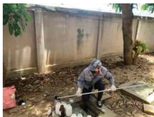
ภาพที่ 3.5.4-1 แสดงวิธีการเก็บตัวอย่างคุณภาพน้ำทิ้ง
